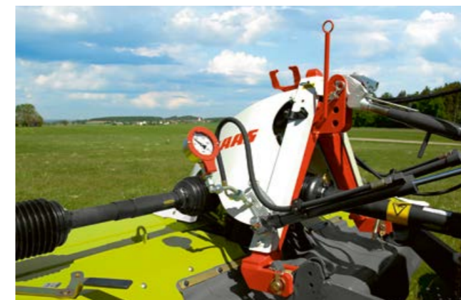
Optionale hydraulische Entlastung ACTIVE FLOAT für Frontmähwerke.
