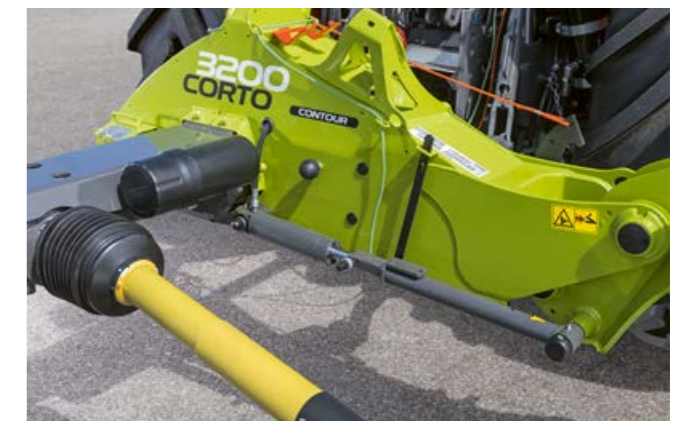
ACTIVE FLOAT Zylinder für die hydraulische Entlastung des CORTO 3200 CONTOUR.
