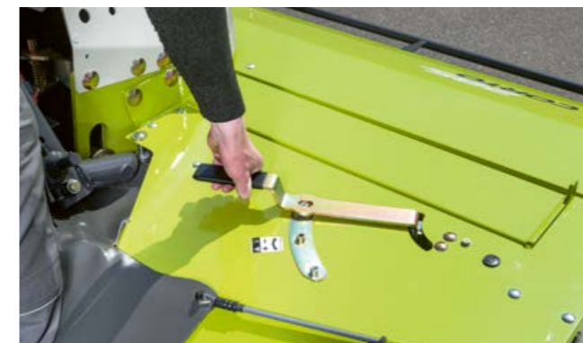
Schwadscheibenverstellung mit einem Handgriff.
