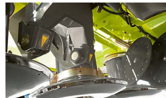
Der bodennahe Drehpunkt sichert eine optimale Längsanpassung des Mähwerks.
